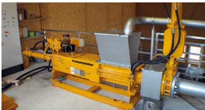
Bomba EKO 1060 PP na planta de biometanização de Kössen (Áustria) para o transporte e acondicionamento de alimentos deteriorados
