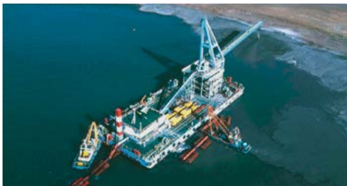
Três enormes bombas de pistão KOS 25100 e 25200 bombeando lama para erguer uma ilha artificial na frente da linha costeira japonesa
