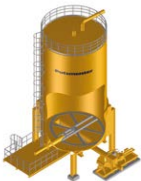
Silo de armazenamento com base dupla retangular deslizante e bomba de carga
